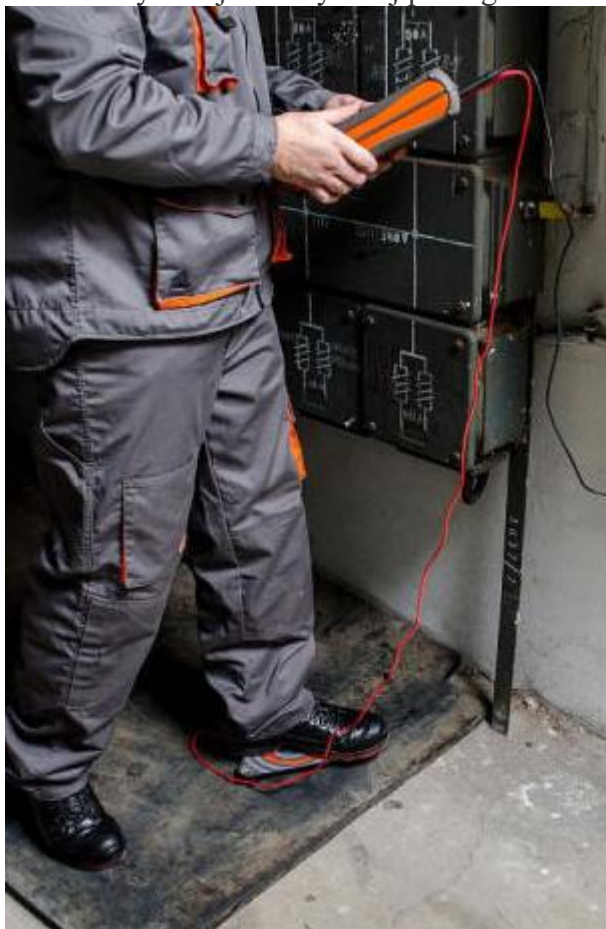
Rys. 10. Pomiar rezystancji elektrycznej podłogi lub ściany za pomocą MIC-10 or
