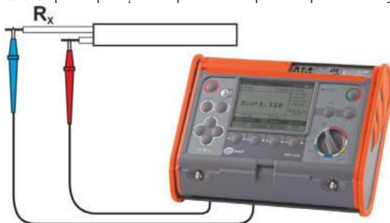
Rys. 7. Pomiar rezystancji izolacji miernikiem MPI-525.
