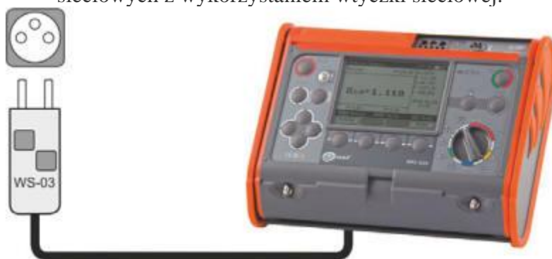
Rys. 8. Pomiar rezystancji izolacji w gniazdku sieciowym przewodami z wtykiem UNI-Schuko (MPI-530/520).
