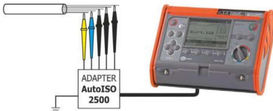
Rys. 9. Pomiar przewodów wielożyłowych przy wykorzystaniu adaptera AutoISO-2500.
